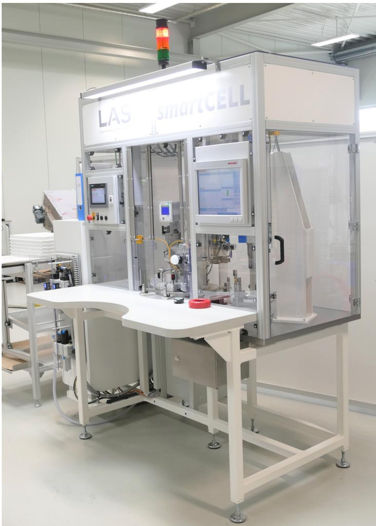
Die **protoCELL**-Grundmaschine mit pneumatischer Antriebslösung ist ideal für die Qualifizierung neuer Prozesse und zur Überprüfung neuer Produkte.
