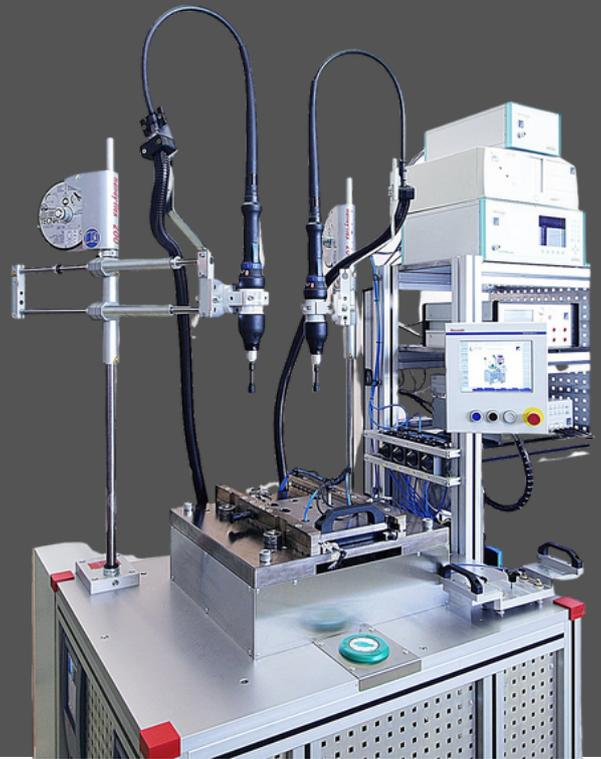
Für den schnellen und kostengünstigen Start in die Nullserienproduktion bietet LAS halbautomatische Lösungen, basierend auf der **protoCELL**. Dabei werden in der Regel nur die Montageschritte automatisiert, die nicht manuell ausgeführt werden können, wie zum Beispiel Stanz-, Schraub- und Schweißvorgänge. Die Einzelteile des zu montierenden Produktes legt üblicherweise eine Bedienerperson ein.
