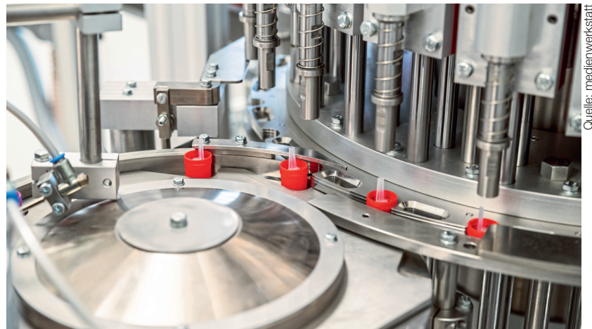
Nach der Montage der Schraubkappen und Tropfereinsätze erfolgt eine Höhenkontrolle, um fehlerhafte Teile auszusortieren.
